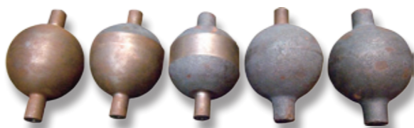
右端の鋳物の球がだんだん加工されていく
