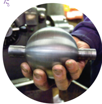
14工程を経てヒカヒカの砲丸に削り上げる
