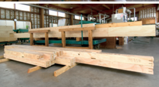
写真⑥ プレカットされた構造用部材
